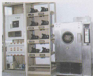
图3 漏电开关试验装置照片
